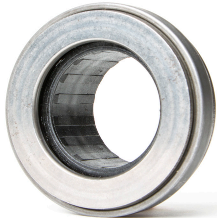
Зображення 2: Забороняється змащувати витискні підшипники з пластмасовими втулками
