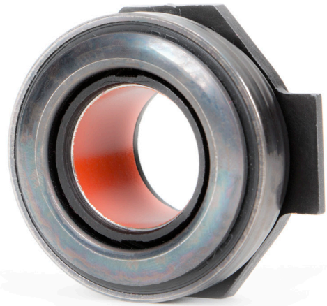
Зображення 3: Забороняється змащувати витискні підшипники, що мають втулки з політетрафторетиленовим (PTFE) покриттям
